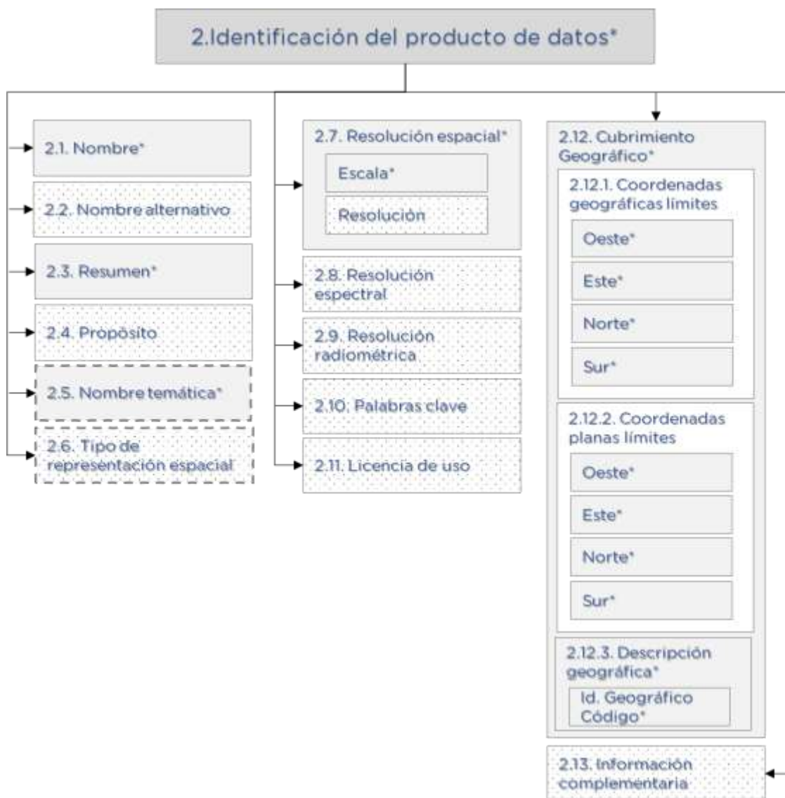
F 13 Sección Identificación del producto de datos Fuente: Instructivo Especificaciones Técnicas de Productos Geográficos
